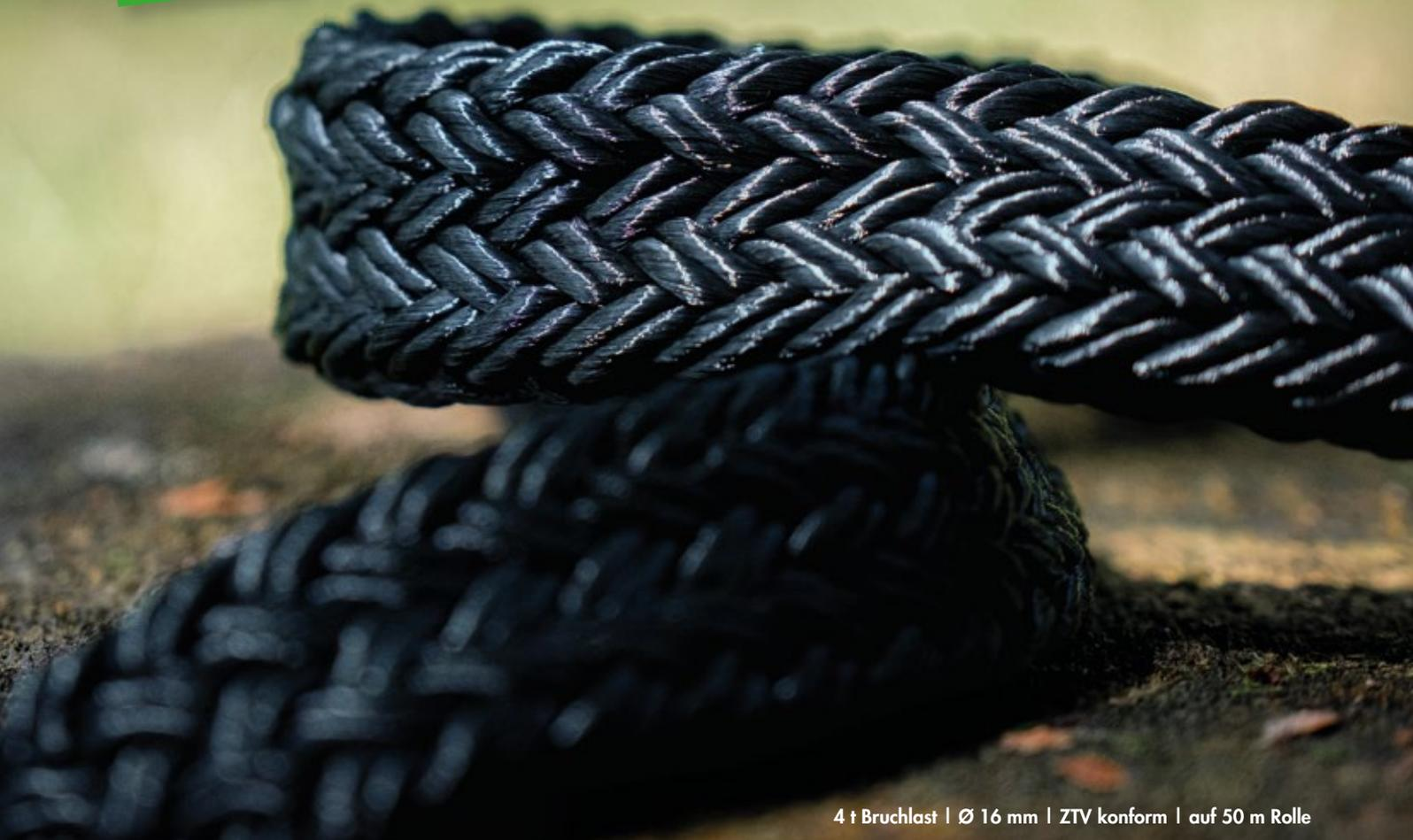
4 t Bruchlast | Ø 16 mm | ZTV konform | auf 50 m Rolle
